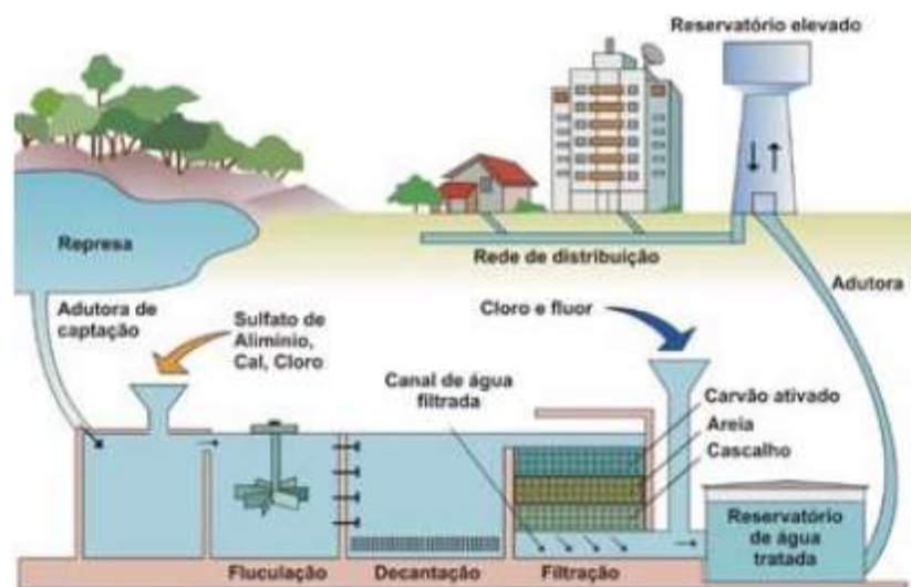
Figura 7: Esquema ilustrativo da coleta, tratamento e distribuição da água.
